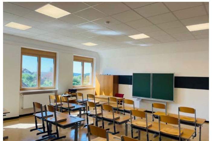
Klassenzimmer mit Schallschutz-Zwischendecken und LED-Beleuchtung
